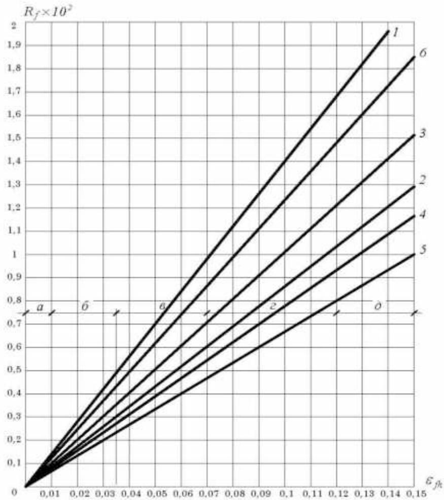
1, 2 – супеси; 3 – суглинки; 4 – суглинки с  $0,07 < I_p \leq 0,13$ ; 5 – суглинки с  $0,13 < I_p \leq 0,17$ ; 6 – глины (в грунтах 2, 4 и 5 содержание пылеватых частиц размером 0,05–0,005 мм составляет более 50 % по массе); а – практически непучинистый; б – слабопучинистый; в – среднепучинистый; г – сильнопучинистый; д – чрезмернопучинистый
