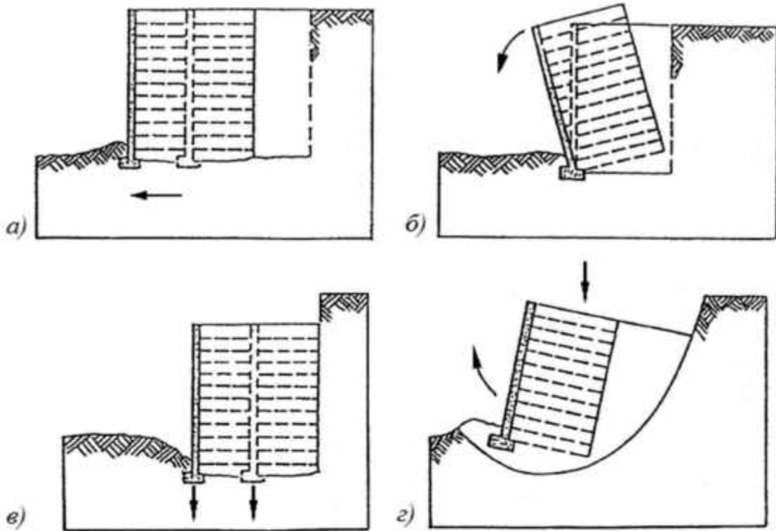
*a* – сдвиг по подошве; *б* – опрокидывание; *в* – потеря несущей способности подстилающего массива грунта; *г* – глубинный сдвиг
