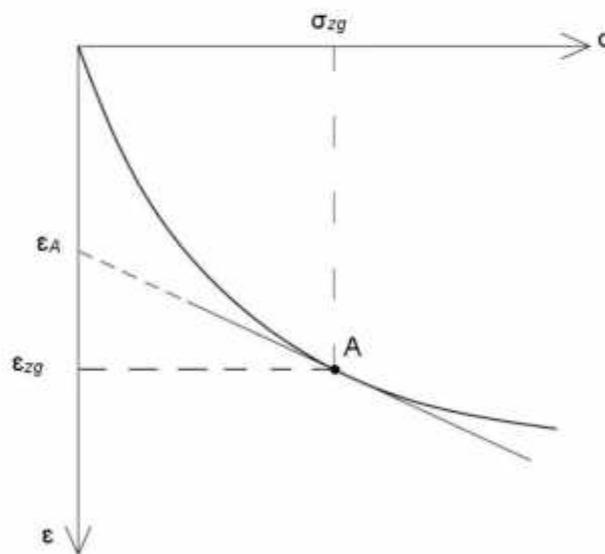
$\sigma$  — вертикальное напряжение, МПа;  $\varepsilon$  — относительная деформация;  $\sigma_{zg}$  — природное вертикальное эффективное напряжение, МПа;  $\varepsilon_A$  — условная величина относительной деформации, соответствующая точке пересечения касательной к компрессионной кривой в точке A с осью  $\varepsilon$ ;  $\varepsilon_{zg}$  — величина относительной деформации, соответствующая  $\sigma_{zg}$
