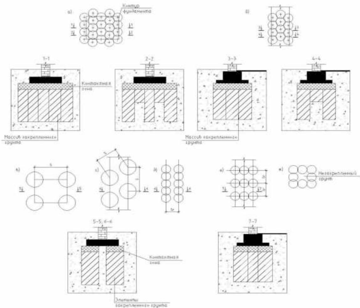
а, б – сплошное из рядом расположенных элементов; в, г – отдельно стоящих элементов; д, е, жс – отдельно расположенных рядов сплошных элементов
