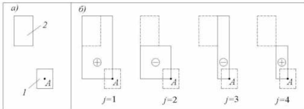
*a* – схема расположения рассчитываемого *1* и влияющего фундамента *2*; *б* – схема расположения фиктивных фундаментов с указанием знака напряжений  $\sigma_{zp,aj}$  в формуле (5.21) под углом *j*-го фундамента
