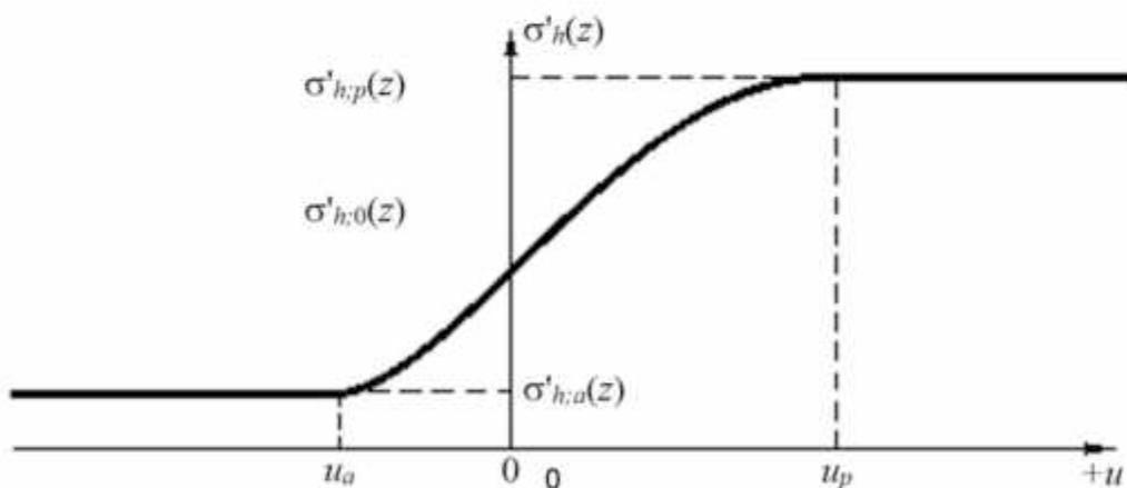
Рисунок 9.1 – Зависимость величин бокового давления грунта  $\sigma'_h(z)$  от горизонтальных перемещений конструкции  $u$ , где  $u_a = 0,001h$ ,  $u_p = (0,01-0,02)h$
