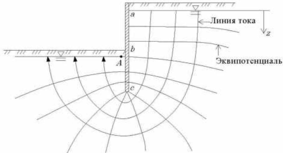
Рисунок 9.3 – Фильтрация в котлован при несовершенной ПФЗ
