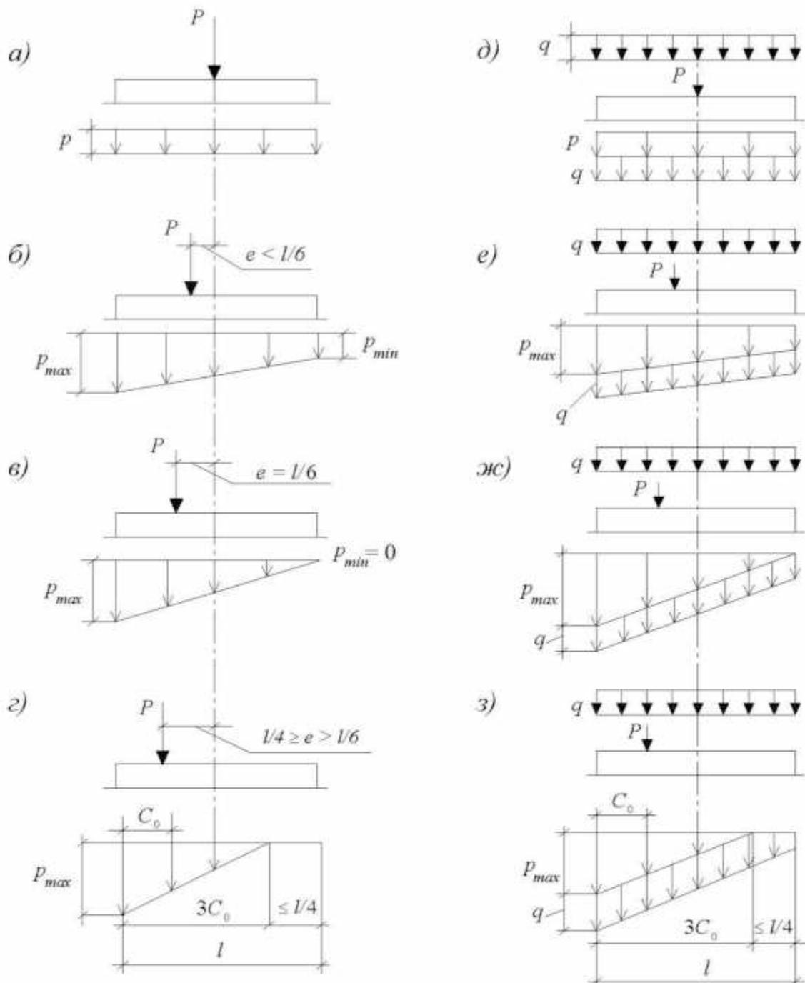
*a-z* – при отсутствии нагрузок на полы; *д-з* – при сплошной равномерно распределенной нагрузке интенсивностью  $q$ ; *a* и *д* – при центральной нагрузке; *б* и *е* – при эксцентриситете нагрузки  $e < l/6$ ; *в* и *ж* – при  $e = l/6$ ; *з* и *з* – при  $e > l/6$  (с частичным отрывом фундамента от грунта)
