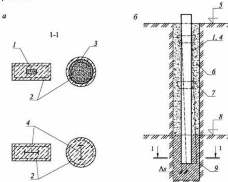
*а* – поперечное сечение; *б* – продольное сечение, отклонение от вертикали; 1 – железобетонная опора перекрытия; 2 – арматурный каркас; 3 – опора из стальной трубы с железобетонным заполнением; 4 – стальная опора перекрытия; 5 – рабочая площадка; 6 – засыпка щебнем; 7 – опорный столик; 8 – отметка разработки; 9 – фундамент опоры;  $\Delta s$  – отклонение опоры
