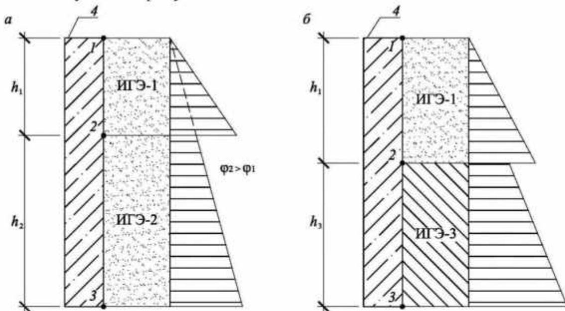
*а – в несвязных грунтах; б – в несвязных и связных грунтах; 1, 2, 3 – точки, для которых должны быть определены характерные значения давления; 4 – подпорное сооружение; ИГЭ-1 ( $y_1, \phi_1, c_1=0$ ), ИГЭ-2 ( $y_2, \phi_2, c_2=0$ ), ИГЭ-3 ( $y_3, \phi_3, c_3 \neq 0$ ) – номер инженерно-геологического элемента,  $h_1, h_2$  и  $h_3$  – высота соответствующего слоя грунта*
