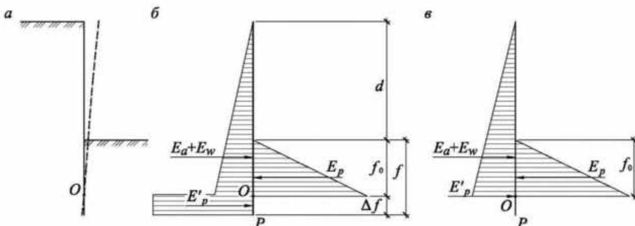
*a – деформированная схема; б, в – последовательная аппроксимация активного и пассивного давления;  $d$  – глубина котлована;  $f$  – заделка стены в грунт;  $O$  – точка нулевого момента в стене;  $P$  – низ подпорного сооружения;  $E_a$  – равнодействующая активного давления грунта;  $E_p$  – равнодействующая пассивного давления грунта;  $E_w$  – равнодействующая давления подземных вод;  $E'_p$  – равнодействующая противодавления грунта ниже точки нулевого момента*
