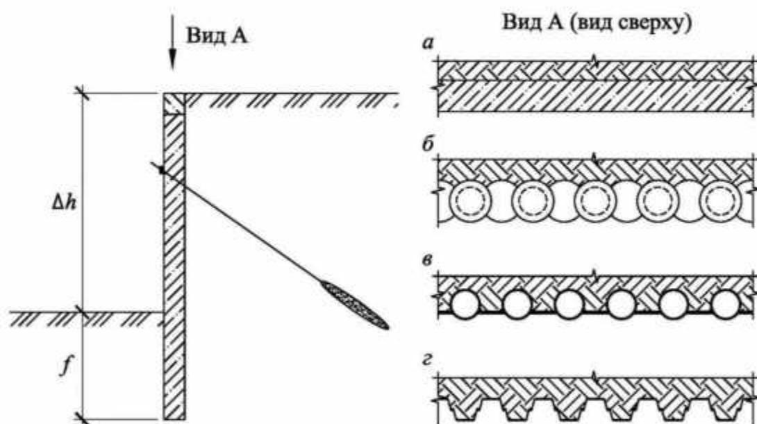
*а – траншейная железобетонная «стена в грунте»; б – ограждение из буросекущихся свай; в – ограждение из металлических труб с забиркой; г – шпунтовое ограждение типа «Ларсен»;  $\Delta h$  – перепад высот;  $f$  – зона заделки*
