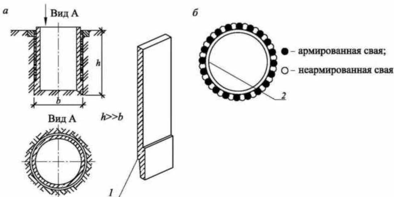
*a* – колодец (камера) из сборных железобетонных элементов; *б* – колодец (камера) из буросекущихся свай; 1 – сборный железобетонный элемент; 2 – обвязочный пояс; *b* – диаметр колодца (камеры); *h* – высота колодца (камеры), при этом *h* значительно больше *b*
