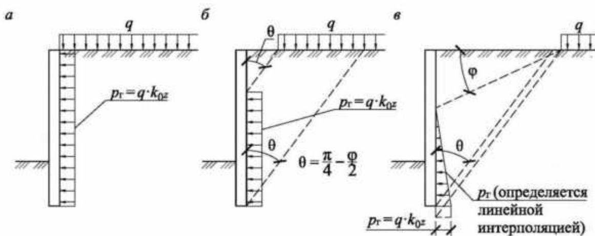
Рисунок Е.6 – Схема распределения давления  $p_r$  от полубесконечной нагрузки
