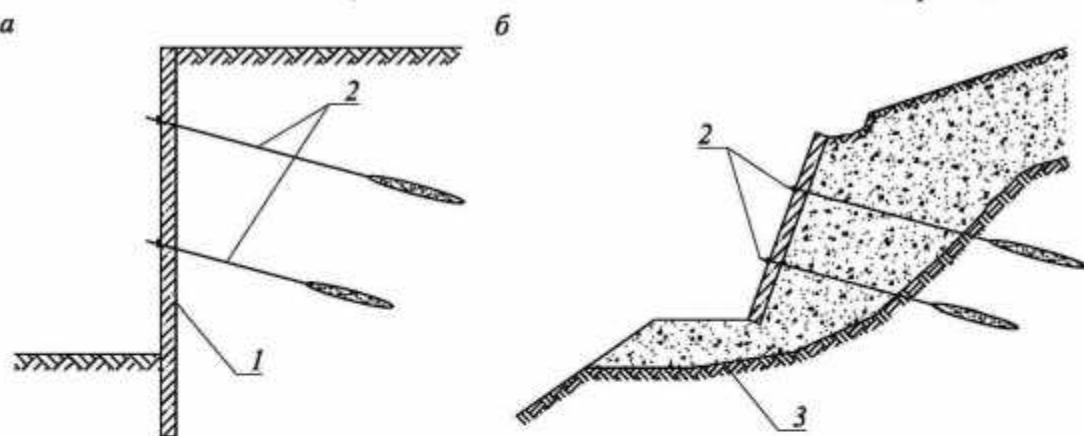
*а – для крепления подпорного сооружения; б – для крепления откоса или склона;
