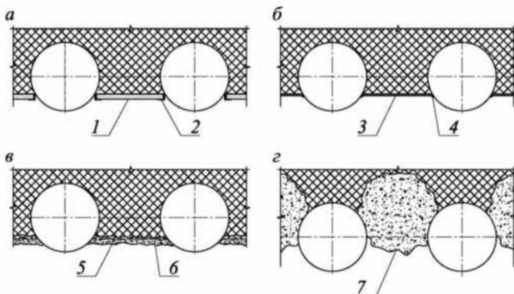
*а – деревянная; б – металлическая; в – из набрызг-бетона; г – из грунтоцементных элементов; 1 – деревянная доска; 2 – стальной уголок; 3 – металлическая пластина; 4 – сварной шов; 5 – арматурная сетка; 6 – набрызг-бетон; 7 – грунтоцементные элементы*
