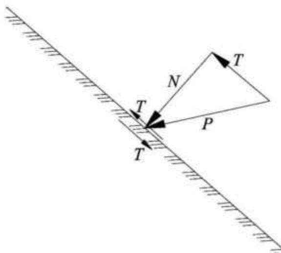
$P$  – равнодействующая давления или реакции грунта на грань сооружения;  $N$  – нормальная составляющая равнодействующей;  $T$  – касательная составляющая равнодействующей
