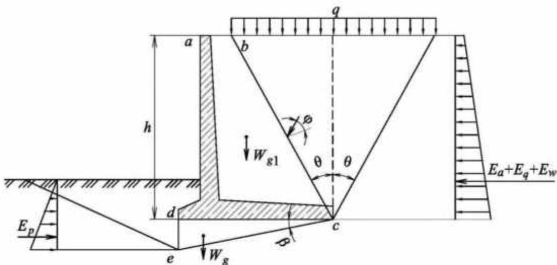
*а* – массивных стен; *б* – уголковых стен;  $W_{g1}$  – равнодействующая веса грунта в объеме  $abcd$ ;  $W_g$  – равнодействующая веса грунта в объеме  $cde$ ;  $\gamma_{dk}$  – коэффициент условий работы на контакте;  $\beta$  – угол наклона поверхности скольжения к горизонту
