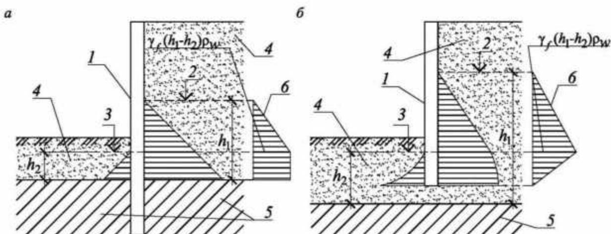
а – при отсутствии фильтрации под подошвой подпорного сооружения; б – в случае
