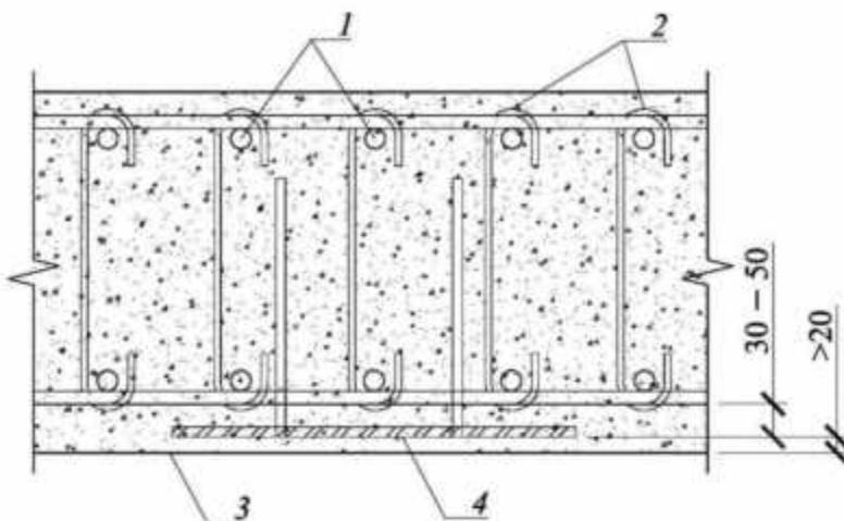
1 – продольное армирование; 2 – поперечное армирование; 3 – граница траншеи «стены в грунте»; 4 – закладная деталь
