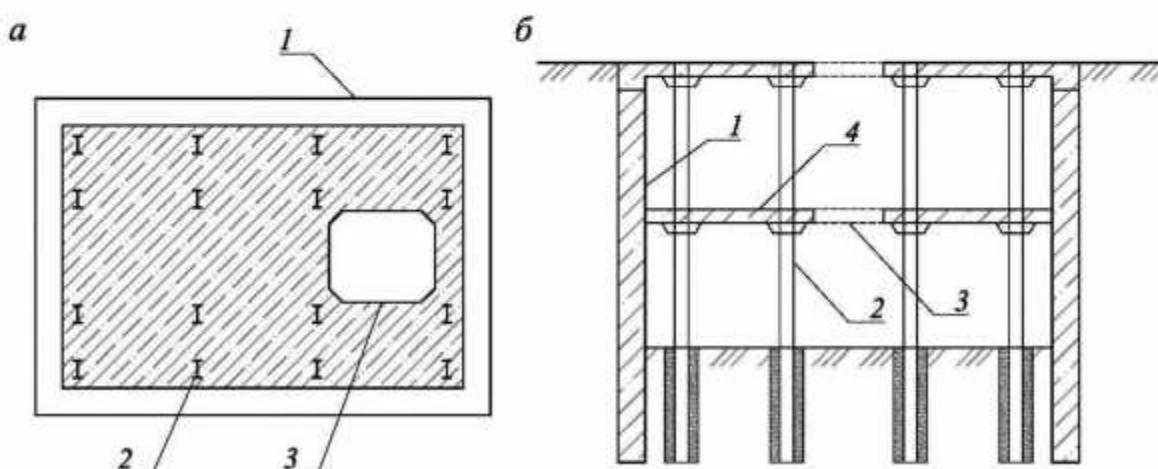
*a – план; б – сечение; 1 – подпорное сооружение; 2 – опора перекрытия; 3 – технологический проем; 4 – перекрытие*
