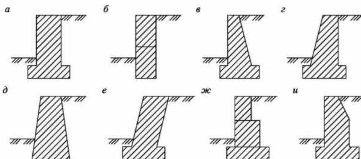
а, б – с двумя вертикальными гранями; в – с вертикальной лицевой и наклонной тыльной гранями; г – с наклонной лицевой и вертикальной тыльной гранями; д – с двумя симметричными наклонными гранями; е – с двумя наклонными в сторону засыпки гранями; ж – со ступенчатой тыльной гранью; и – с ломаной тыльной гранью
