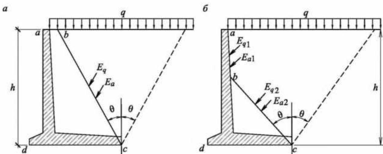
*а* – при симметричной призме обрушения; *б* – при короткой консоли и несимметричной призме обрушения;  $E_{q1}$ ,  $E_{q2}$  – горизонтальная составляющая давления от поверхностной нагрузки выше и ниже точки  $b$  соответственно;  $E_{a1}$ ,  $E_{a2}$  – горизонтальная составляющая активного давления выше и ниже точки  $b$  соответственно.
