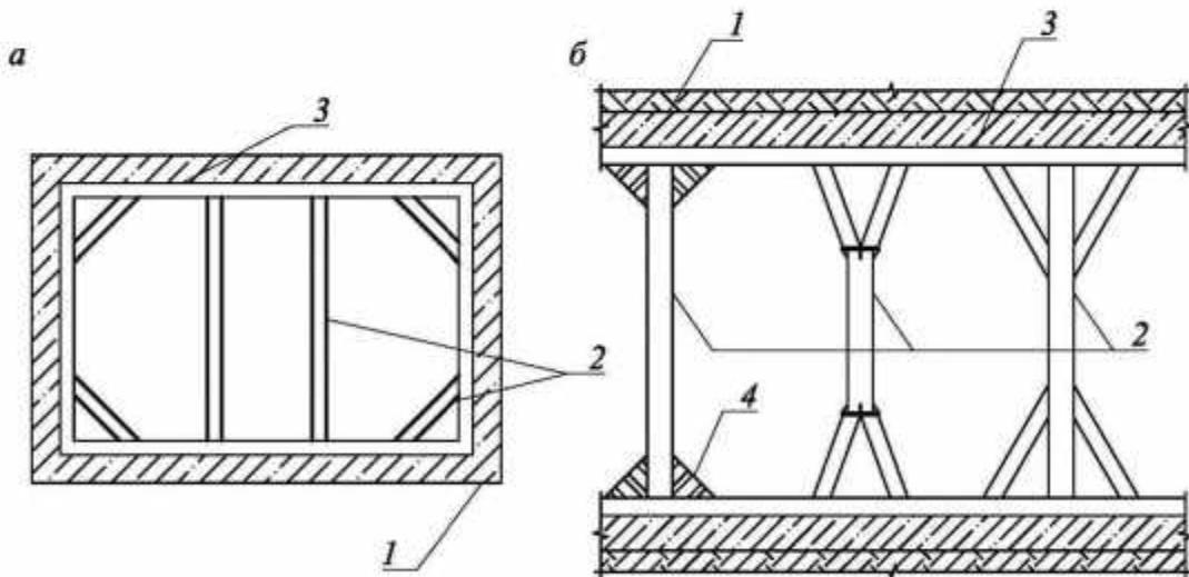
*a – схема расстановки распорных элементов в плане при рядовом шаге распорок; б – примеры узлов опирания распорных элементов при большом шаге распорок в плане; 1 – подпорное сооружение; 2 – распорка; 3 – распределительный пояс; 4 – лист*
