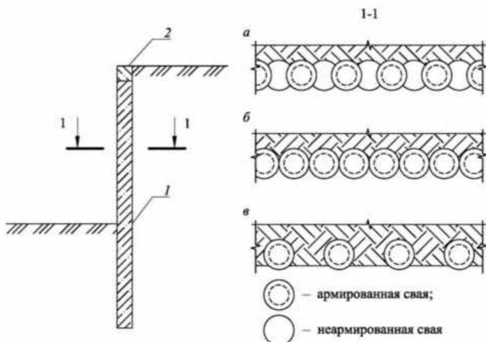
*a – ограждение из буросекущихся свай; б – ограждение из бурокасательных свай; в – ограждение из отдельно стоящих свай; 1 – подпорное сооружение; 2 – обвязочная балка*
