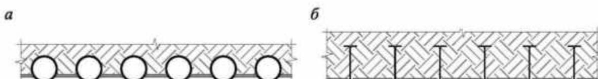
*a – ограждение из металлических труб с забиркой; б – ограждение из прокатных профилей*
