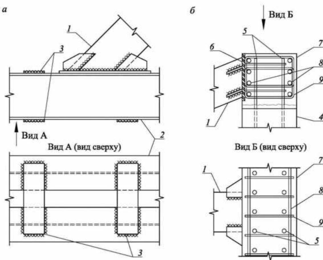
*a – стального; б – монолитного железобетонного; 1 – распорка; 2 – распределительный пояс; 3 – пластины раскрепления пояса по длине; 4 – контур подпорной стены; 5 – армирование подпорной стены; 6 – закладная деталь; 7 – контур распределительного пояса; 8 – продольное армирование распределительного пояса; 9 – поперечное армирование распределительного пояса*
