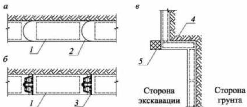
*а – полукруглый грейфер; б – плоский грейфер или гидрофреза; в – угловая захватка; 1 – арматурный каркас; 2 – ограничитель захваток полукруглого типа; 3 – ограничитель захваток с гидрошпонкой; 4 – проектный контур «стены в грунте»; 5 – демонтируемый участок*
