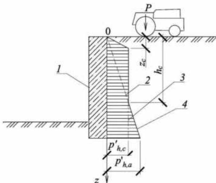
1 – подпорная конструкция; 2 – эпюра активного давления грунта; 3 – эпюра бокового давления от уплотнения; 4 – результирующая эпюра давления;  $P$  – подвижная эквивалентная полосовая нагрузка от уплотняющего механизма;  $z$  – вертикальная координата;  $p'_{h,a}$  – активное давление;  $p'_{h,c}$  – давление уплотнения
