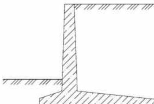
*Рисунок Г.2 – Уголковая подпорная стена*
