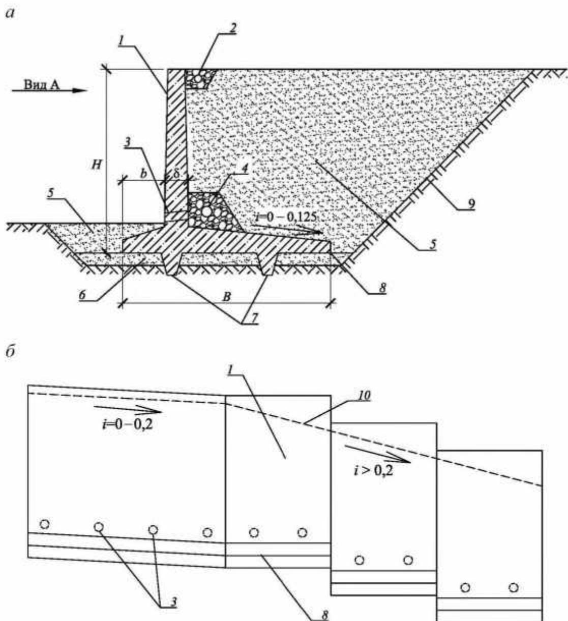
*a* – поперечное сечение; *б* – вид спереди (вид А); *1* – лицевая стенка; *2* – водоотводной кювет; *3* – дренажные трубы (шаг ~ 3–6 м); *4* – пристенный дренаж; *5* – обратная засыпка; *6* – подготовка основания «постель»; *7* – «зуб»; *8* – фундаментная плита; *9* – контур траншеи; *10* – контур поверхности земли; *i* – уклон
