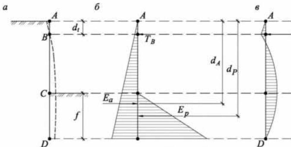
*a* – деформированная схема конструкции; *б* – эпюры активного и пассивного давления; *в* – эпюра изгибающих моментов в стене;  $d_t$  – глубина установки яруса крепления;  $f$  – искомая глубина заделки;  $T_B$  – искомое усилие в элементе крепления;  $d_A$  и  $d_p$  – расстояние от верха подпорного сооружения до равнодействующей активного и пассивного давления соответственно
