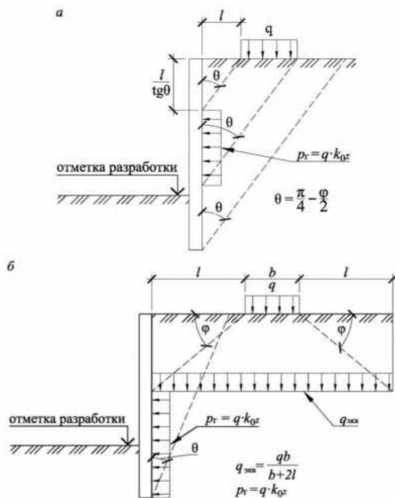
Рисунок Е.7 – Схема распределения давления  $p_r$  от равномерно распределенной полосовой нагрузки
