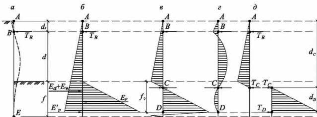
*a* – деформированная схема конструкции; *б, в* – последовательная аппроксимация активного и пассивного давления; *г* – эпюра изгибающих моментов в стене; *д* – разбиение конструкции на эквивалентные балки;  $d_1$  – глубина установки яруса крепления;  $d_C$  – глубина точки нулевого момента в стене;  $C$  – точка нулевого момента в стене;  $T_B$  – усилие в элементе крепления;  $T_C$  и  $T_D$  – усилия в условных опорах;  $d_D$  – расстояние от точки  $C$  до точки  $D$
