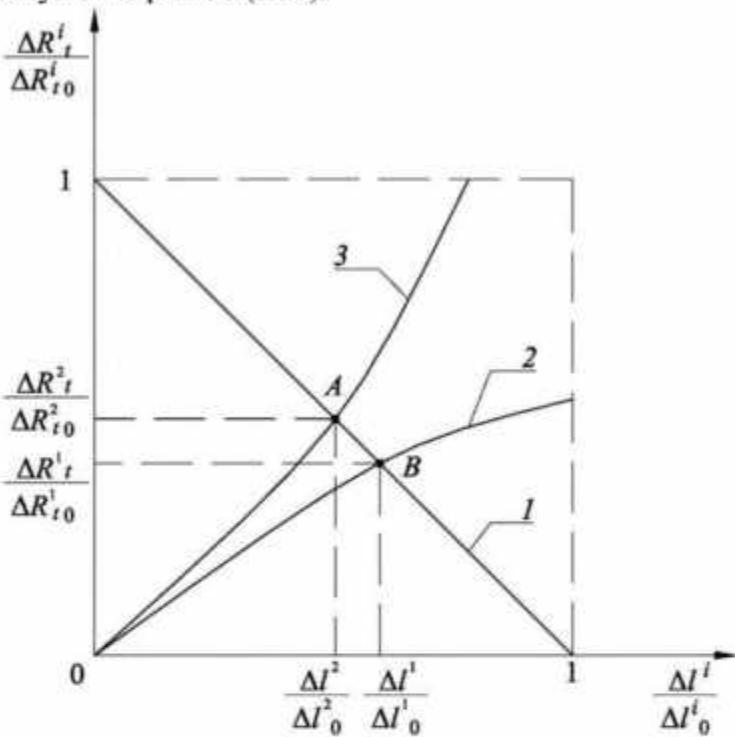
1 – зависимость расчетного значения дополнительного усилия в распорном элементе  $\Delta R_t^i$  от его температурной деформации; 2, 3 – зависимости перемещений подпорной конструкции в точке крепления  $i$ -й распорки от дополнительного усилия в ней;
