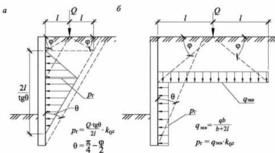
Рисунок Е.8 – Схема распределения давления  $p_r$  от линейной полосовой нагрузки  $Q$
