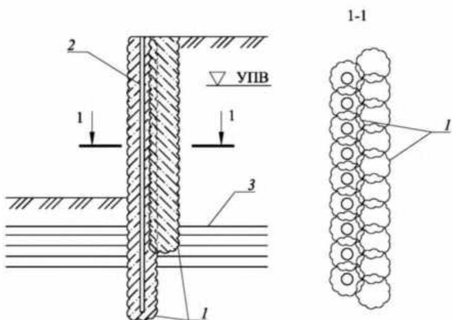
1 – грунтоцементные элементы; 2 – армирующий элемент; 3 – водоупор
