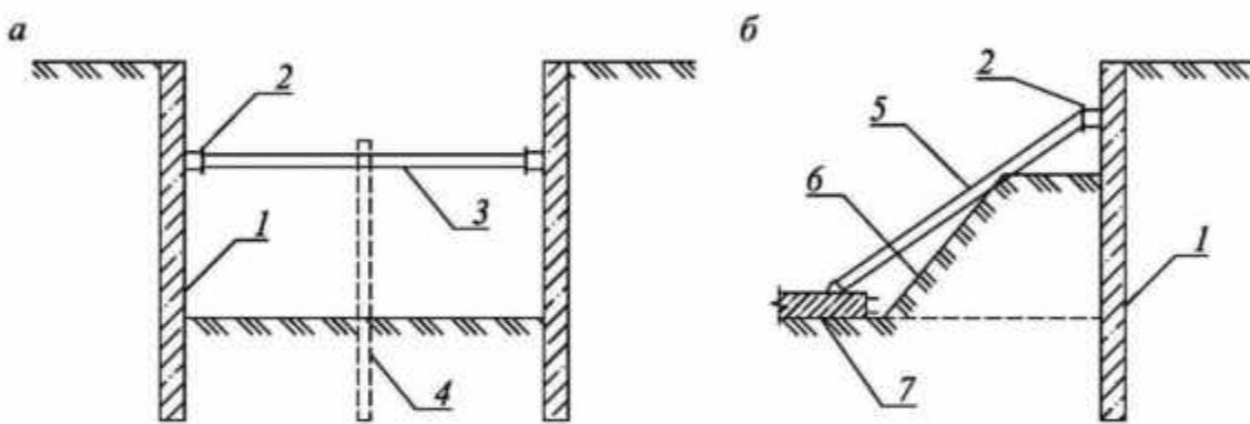
*а – горизонтальная распорная система; б – наклонные подкосы; 1 – подпорное сооружение; 2 – распределительный пояс; 3 – распорка; 4 – промежуточная опора; 5 – подкос; 6 – грунтовая берма; 7 – пионерный участок фундаментной плиты*
