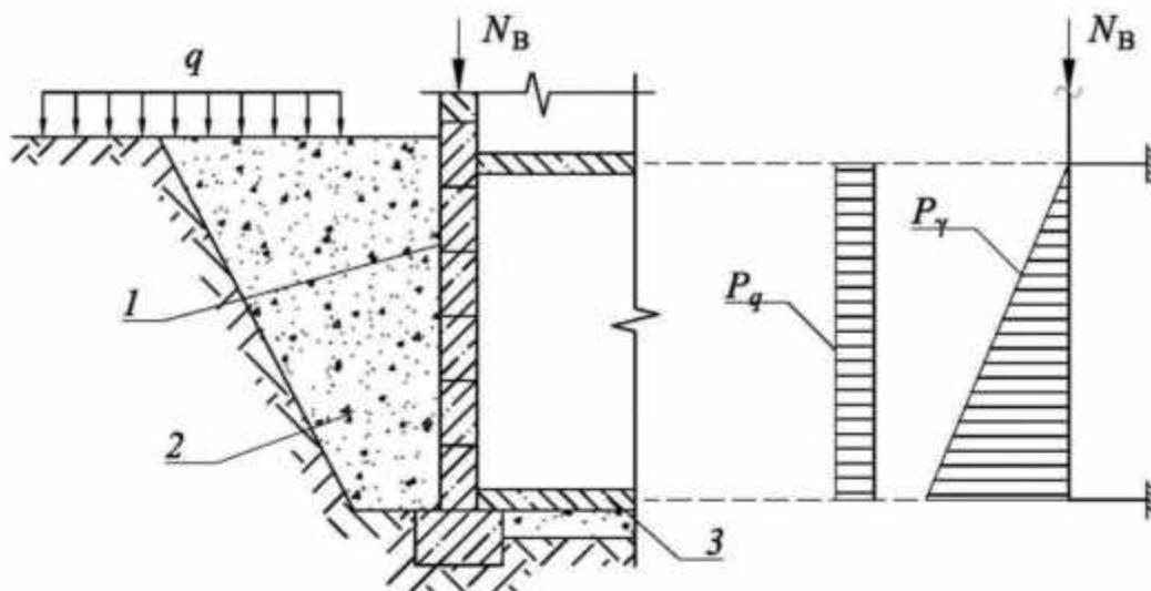
1 – стена подвала; 2 – обратная засыпка; 3 – плита пола подвала;  $p_q$  – давление от нагрузки на поверхности;  $p_y$  – давление от веса грунта
