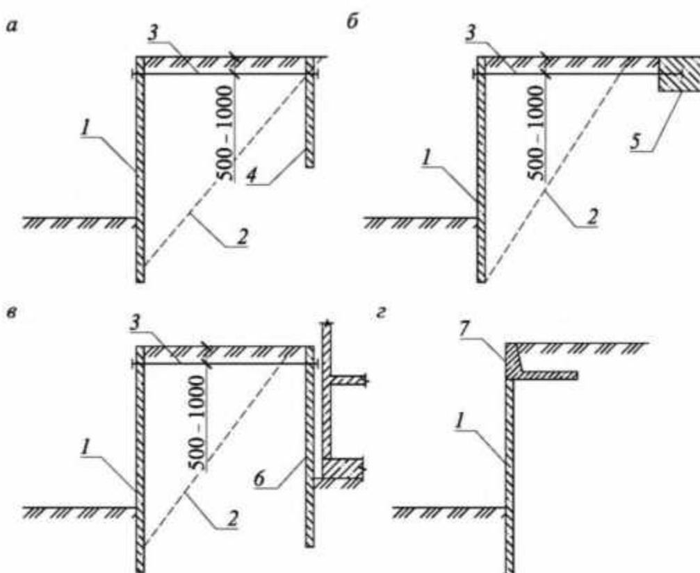
*a – анкерная свая; б – анкерная плита; в – анкеровка за соседнее сооружение; г – разгрузочная плита; 1 – подпорное сооружение; 2 – призма активного давления; 3 – анкерная тяга; 4 – анкерная свая; 5 – анкерная плита; 6 – подпорное сооружение соседнего здания; 7 – разгрузочная плита*
