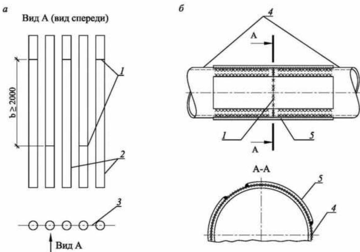
*a – расположение стыков по высоте элементов по периметру сооружения; б – пример стыка металлического элемента; 1 –стыки элементов; 2 – стальные элементы подпорного сооружения; 3 – ось подпорного сооружения; 4 –стыкуемые элементы; 5 – пластины стыка*
