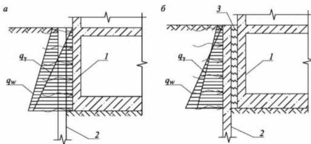
*a – водопроницаемое ограждение; б – водонепроницаемое ограждение; 1 – стена подвала; 2 – подпорное сооружение; 3 – упругие связи;  $q_T$  – эпюра горизонтального давления от веса грунта и нагрузок на поверхности;  $q_W$  – эпюра гидростатического давления воды*
