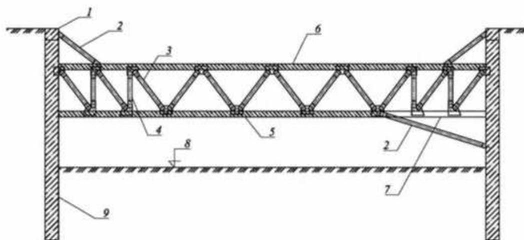
1 – обвязочный пояс; 2 – подкос; 3 – раскос; 4 – стойка; 5 – перекрытие (нижний пояс); 6 – перекрытие (верхний пояс); 7 – технологический проем; 8 – отметка разработки; 9 – «стена в грунте»
