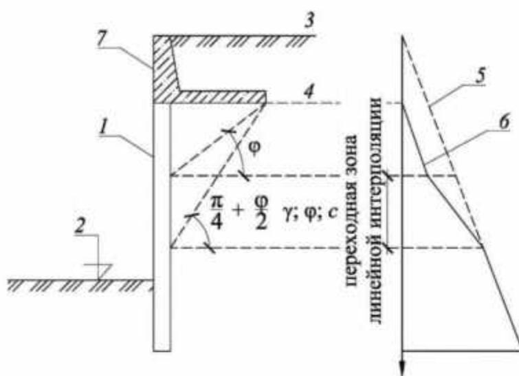
1 – подпорное сооружение; 2 – отметка разработки; 3 – поверхность А; 4 – поверхность В;
