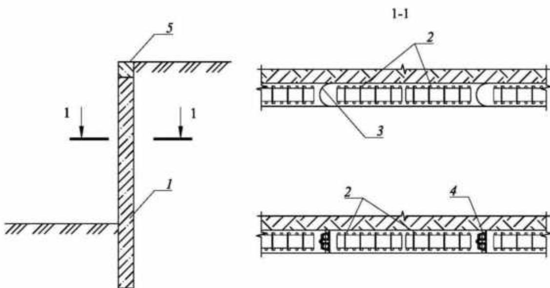
1 – «стена в грунте»; 2 – арматурный каркас; 3 – ограничитель захваток полукруглого типа; 4 – ограничитель захваток с гидрошпонкой; 5 – обвязочная балка
