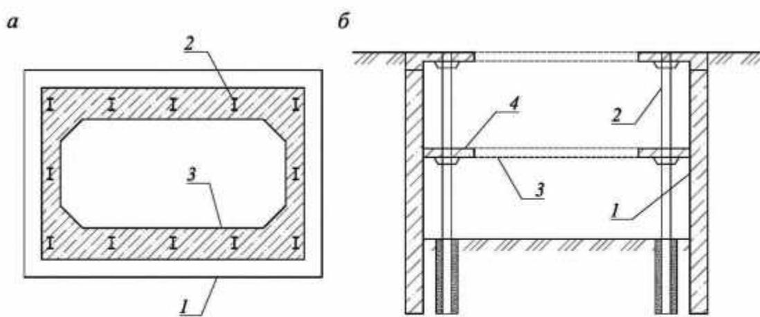
*a – план; б – сечение; 1 – подпорное сооружение; 2 – опора перекрытия; 3 – технологический проем; 4 – перекрытие*
